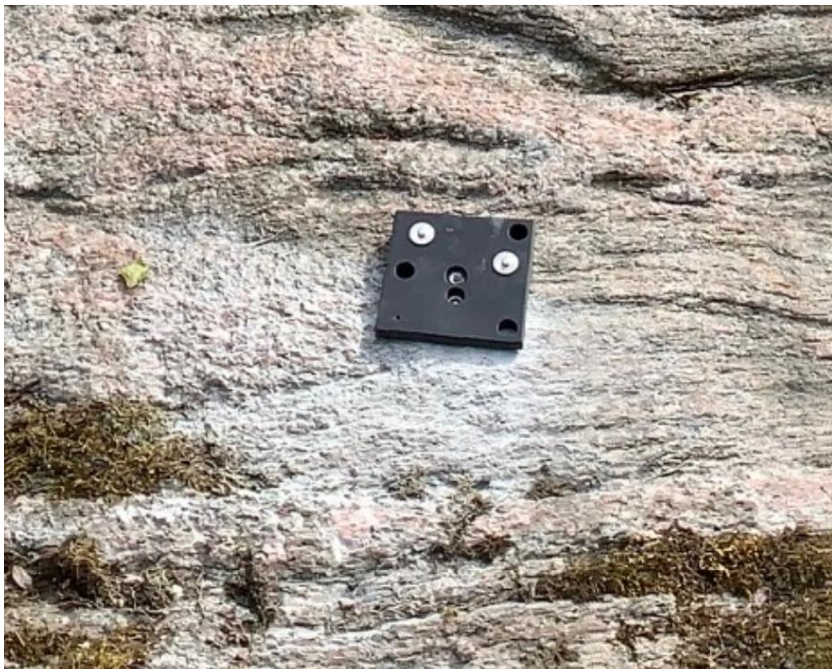
Figur 1 Accelerometern monterades på en 10 mm tjock PVC-platta som skruvades fast mot bergytan.
